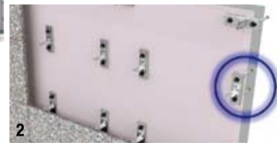
1 신기술이 적용된 문정2구역 엠스테이트 현장 조감도. 2 특수 고정장치를 삽입해 열교차단을 극대화한 신기술 공법 적용 모습.
