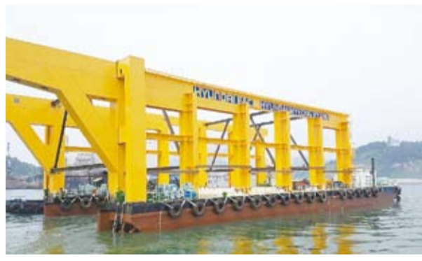
우리 회사가 '능동제어형 조류발전 지지구조시스템 실증공사'를 위해 세계 최초로 고안한 조류발전 설치 및 유지보수 바지선 '현대명량호'.
