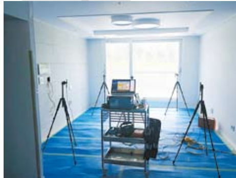
충간소음 저감기술 현장 실증 테스트
